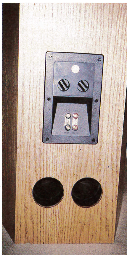
Vista posteriore con le connessioni e le regolazioni per le due vie superiori.
